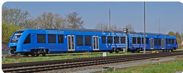
Bildquelle: pixabay.com (Coradia iLint, Wasserstoffzug mit Brennstoffzelle [Fahrgastbeförderungen seit 2018])
